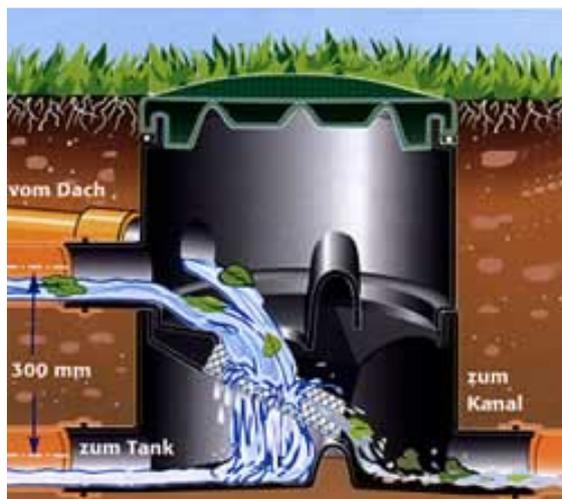
**Figura 28** - Filtro para retenção de materiais sólidos provenientes do telhado, que deverá ficar entre a rede de captação e o depósito.
