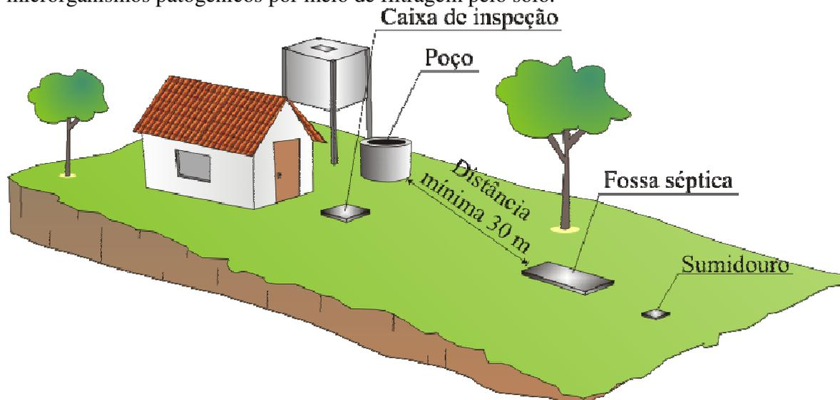
**Figura 23** – Esquema do sistema de distribuição de esgoto domiciliar
